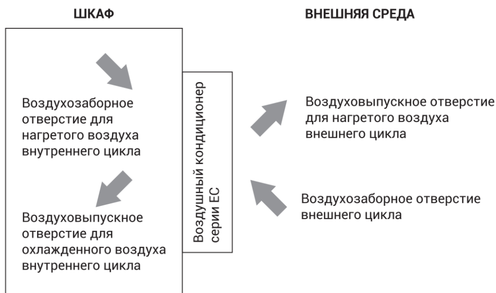
Рисунок 5. Функциональная схема системы климат-контроля
