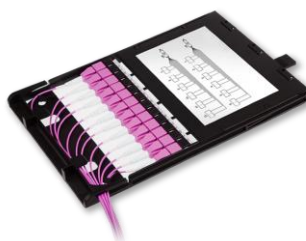
Рисунок 10. Кассетный модуль слотовый серии HD 47M-30, 24 \times LC - 2 \times 12 МТР (male) OM4, полярность А, черный.
