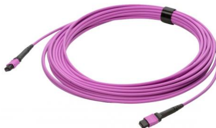
Рисунок 11. Транковый кабель 1 \times МТР PRO (12) – 1 \times МТР PRO (12), 12 волокон, OM4, male-male, полярность тип А
