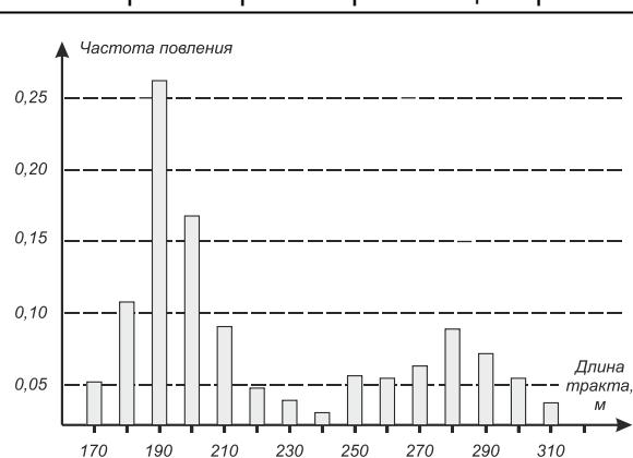
**Рис. 4. Гистограмма ограничений длин симметричных трактов по разбросу задержек (30 нс). Среднее значение 229 м, среднеквадратичное отклонение 55 м**
