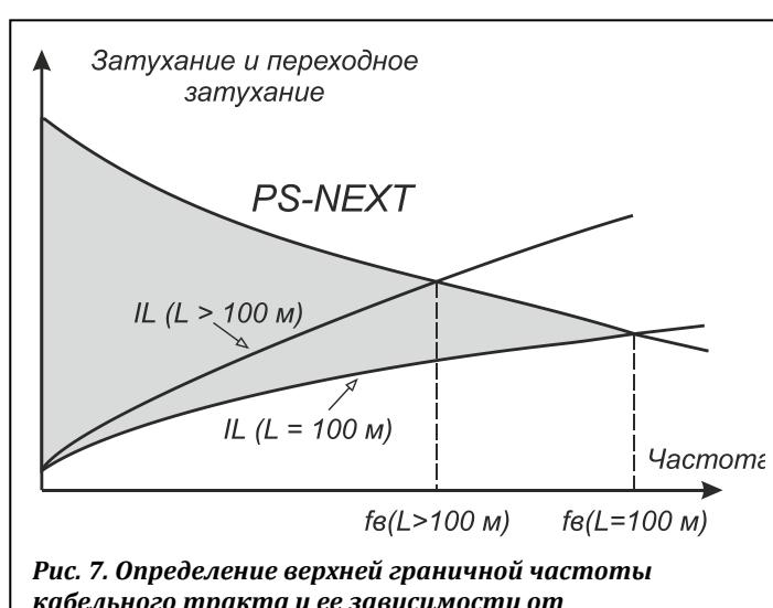
Рис. 7. Определение верхней граничной частоты кабельного тракта и ее зависимости от
