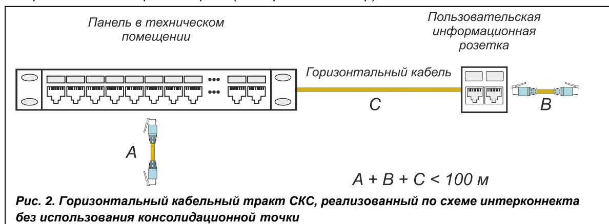
Требования к структуре, а также предельной протяженности как кабельного тракта в целом, так и отдельных его составляющих дополнены в нормативной части стандарта положениями о категории элементной базы, используемой для его формирования. Соблюдение совокупности комплекса этих ограничений гарантирует:
