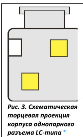
*Рис. 3. Схематическая торцевая проекция корпуса однопарного разъема LC-типа*
