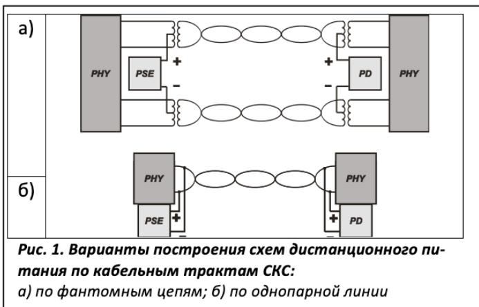
Нормируемые стандартами СКС 4-парная структура горизонтального кабеля, через который осуществляется подключение терминальных устройств, при построении системы ДП учитывается двумя способами:
