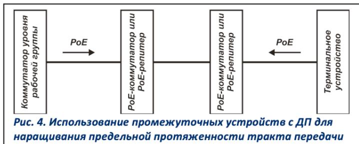
Необходимым условием реализации последней опции является использование в составе этой части ИТС питаемых по PoE многопортовых коммутаторов. Ее применение выгодно в тех случаях, когда ИТС включает в себя системы контроля доступа, видеонаблюдения, управления многочисленными инженерными системами здания и аналогичными им. В случае необходимости простого увеличения дальности связи достаточно простого PoE-репитера.
