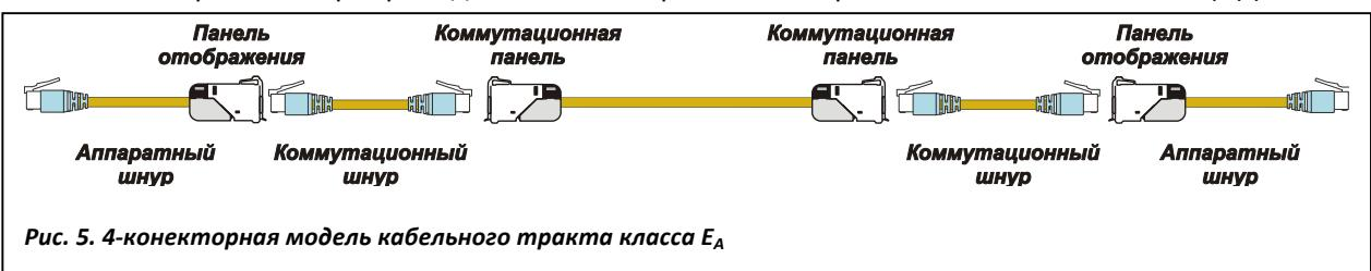
Рис. 5. 4-коннекторная модель кабельного тракта класса  $E_A$
